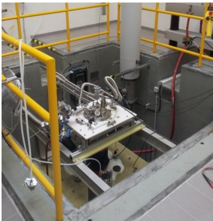
Рис. 22. Магнетометр с образцом, помещенный в камеру с жидким гелием.
