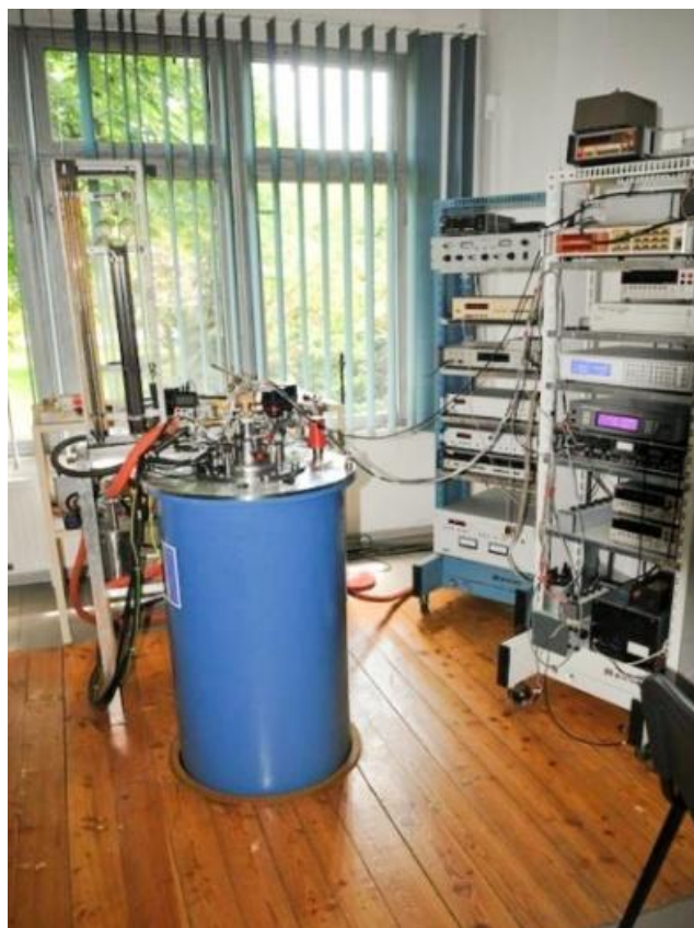
Рис. 23. Сверхпроводящий магнит «Oxford Instruments», имеющий различные вставки для измерения намагниченности, магнитострикции, электросопротивления и других чувствительных к магнитному полю или температуре физических свойств.
