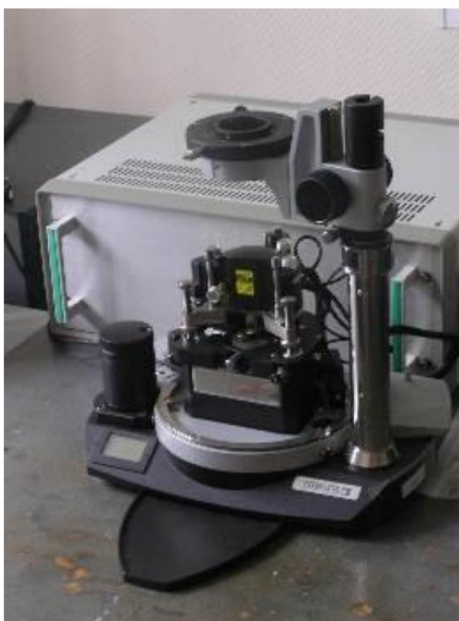
Рис. 20. Внешний вид измерительной головки атомно-силового микроскопа.
