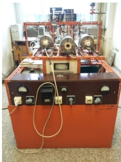
Рис. 18. Установка для проведения процедуры гидрирования с возможностью сохранения монокристаллической структуры редкоземельных интерметаллидов.
